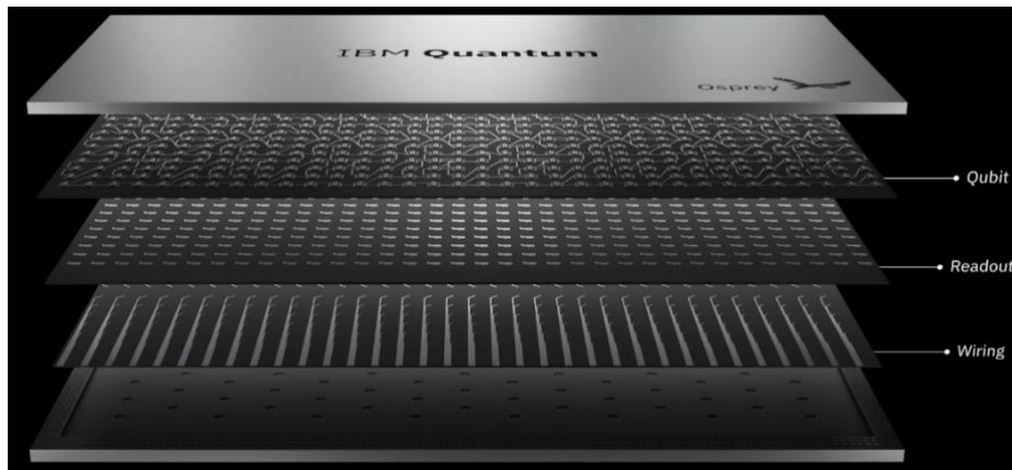
სურათი 2. სუპერჩიპების სამი ძირითადი ფენა: კუბიტი (Qubit), წამკითხველი (Readout), გაყვანილობა (Wiring). წყარო: https://www.notebookcheck.net/IBM-announces-433-qubit-quantum-processor-Bosch-taps-IBM-s-quantum-computers-in-search-for-alternative-EV-metals.667799.0.html
